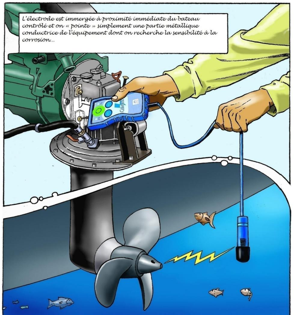
L'électrode est immergée à proximité immédiate du bateau contrôlé et on « pointe » simplement une partie métallique conductrice de l'équipement dont on recherche la sensibilité à la corrosion...
